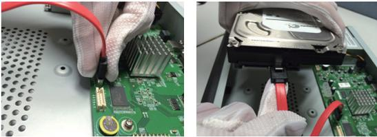
3 Une extrémité connecte une extrémité du câble d'alimentation du disque dur à l'interface SATA de la carte mère NVR, et l'autre extrémité se connecte au disque dur.
