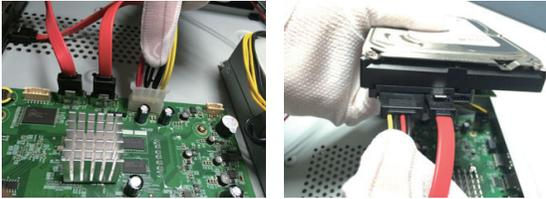
4 固定NVR機箱底部的硬盤螺釘，蓋好機箱上蓋，並用螺絲固定。
