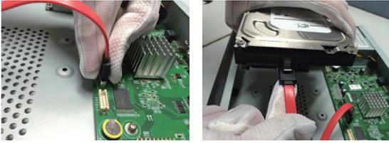
3 將硬盤電源線一端連接到NVR主板的SATA接口上，另一端連接到硬盤上。
