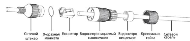
Рис. 3.3 Описание влагонепроницаемого монтажа сетевого кабеля
